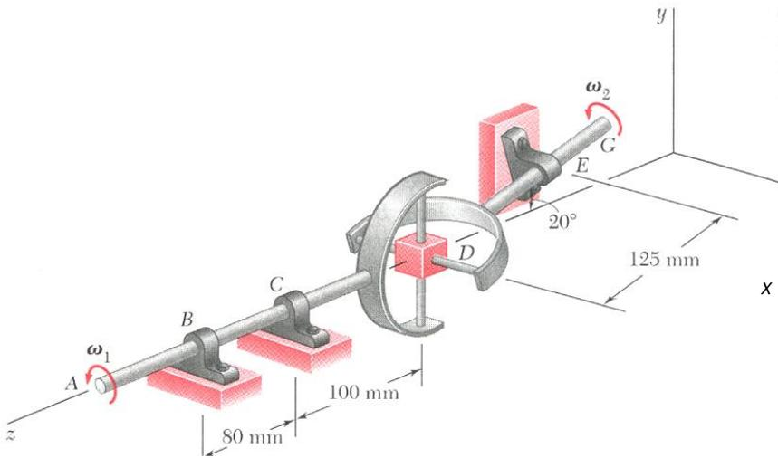
5.- Dos flechas AC y EG, que se encuentran en el plano vertical yz, se conectan mediante una junta universal en D. La flecha AC gira con velocidad angular constante  $\omega_1$  en la forma indicada. En el momento en el que el brazo de la cruceta conectada a la flecha AC está en la posición vertical, determine la velocidad angular de la flecha EG.
